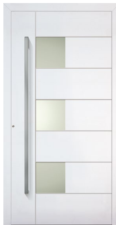
Modell 74500 | Aufsatzfüllung Glas Klarglas Griff Integrierter Griff HA289 halbrund, Edelstahl matt gebürstet Farbe Weiß Modell in Kunststoff und Aluminium RC2 geeignet
