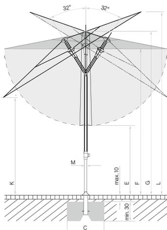
Looser Deckbelag max. 10 cm, Betondicke min. 30 cm (Frosttiefe beachten), Wasserabfluss gewährleisten.
